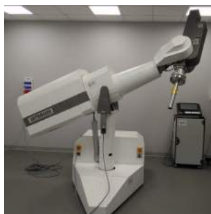
Rysunek 1: Prototyp opracowanego w NCBJ mobilnego akceleratora do radioterapii śródoperacyjnej.
