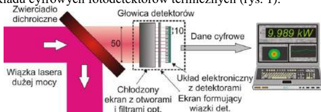
Rys.1. Projekt układu do monitorowania rozkładu wiązki laserów dużej mocy.
